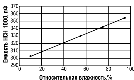
Рис. 2. Типовая характеристика преобразования датчика НСН-1000 (а) и рабочая область (б)
